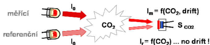
Infračervený NDIR snímač CO 2
