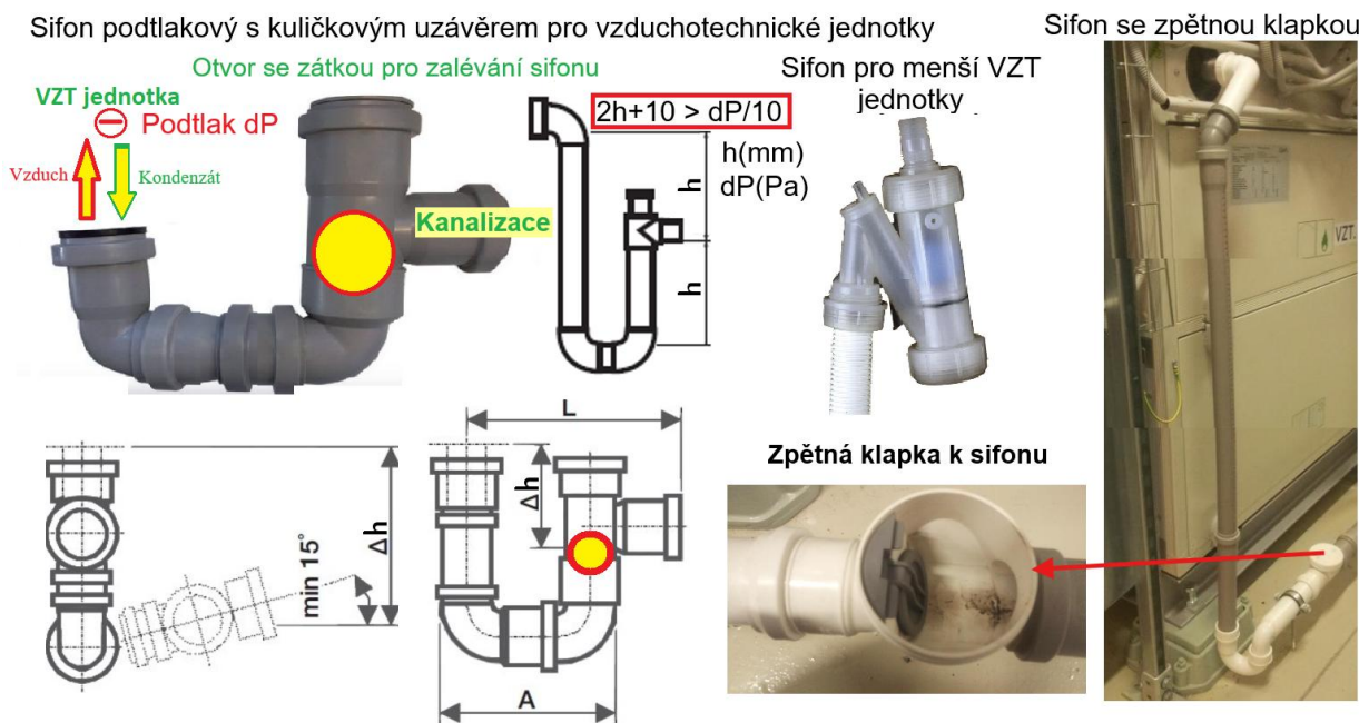
Obr. 13 Příklady podtlakových sifonů k vzduchotechnickým jednotkám
